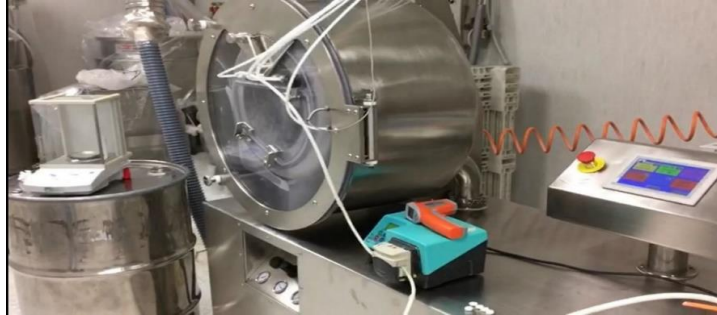
Figura 19. Equipo piloto Jet Coater 10L: tambor rotatorio desde otra perspectiva y panel de control de parámetros.
