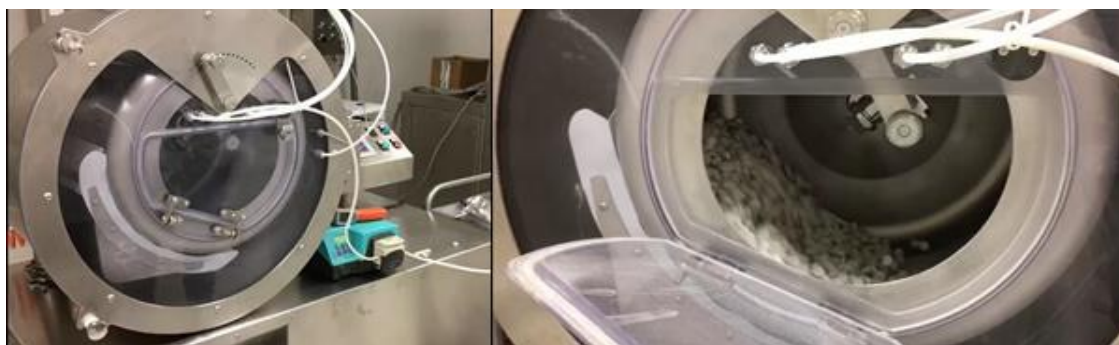
Figura 17 y 18. Equipo piloto Jet Coater 10L: Imagen del tambor rotatorio cerrado y abierto.
