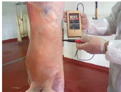
Figura 3.11. Determinación en matadero del pH sobre el músculo Longísimus thoracis et lumborum en una canal lechal del estudio.
