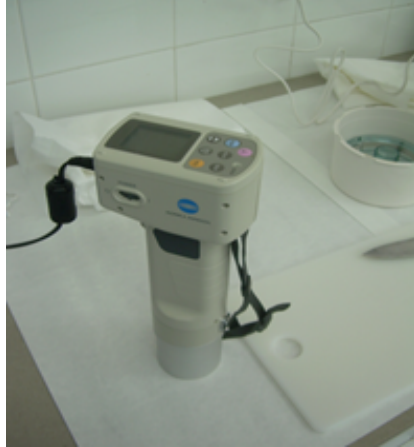
Figura 3.12. Colorímetro utilizado para la medición del color en el músculo Recto del abdomen.
