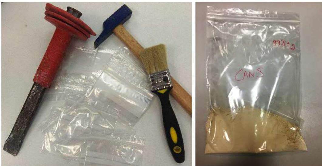
Figura 4.2. Herramientas para la recogida de muestras. Fuente: elaboración propia
