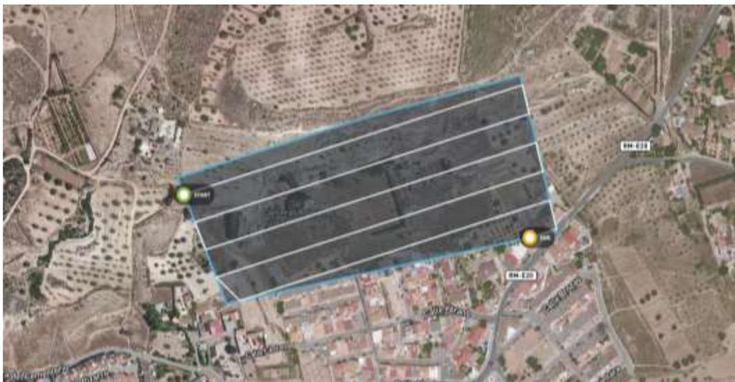
Fig. 4.19. Planificación de vuelo automatizado para fotogrametría aérea. Fuente: elaboración propia
