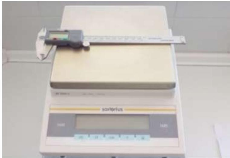
Figura 4.24. Pie de rey y balanza para la determinación de la densidad aparente de la piedra.
