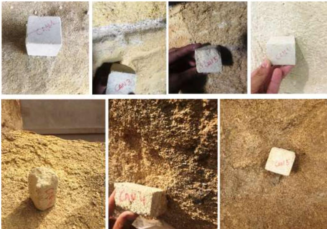
Figura 7.19. Estudio visual comparativo “in situ” entre las distintas construcciones y los litotipos de cantera. Fuente: elaboración propia
