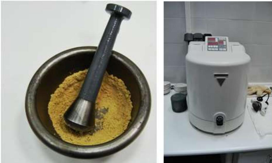
Figura 4.28. Preparación de la muestra con un mortero de ágata (izquierda). Molino Planetario de bolas modelo Pulverisette 6 (derecha). Fuente: elaboración propia
