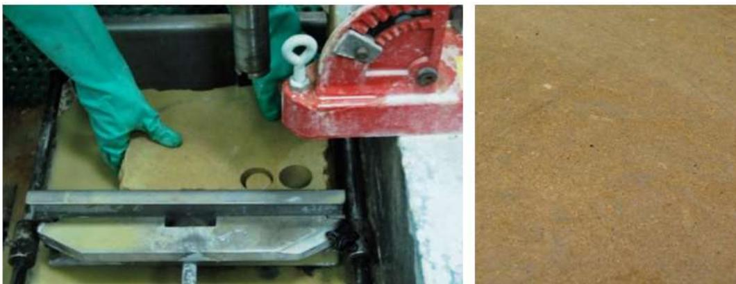
Figura 4.22. Detalle del proceso de extracción de probetas testigo (izquierda). Matriz de la roca visible tras el corte, donde pueden apreciarse restos fósiles (derecha). Fuente: elaboración propia
