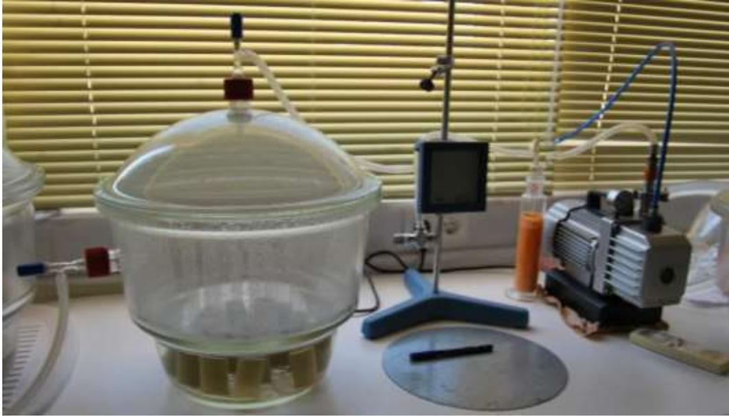
Figura 4.37. Campana y bomba de vacío para el ensayo de porosidad abierta a vacío. Fuente: elaboración propia
