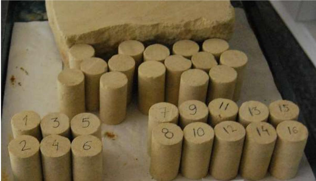
Figura 4.23. Probetas testigo extraídas de MLCAN1. Fuente: elaboración propia. Fuente: elaboración propia
