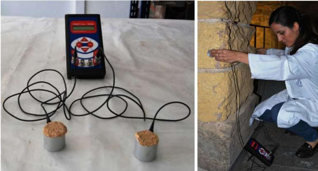
Figura 4.13. Equipo de ultrasonidos (izquierda). Medida “in situ” de la velocidad de ultrasonidos (derecha). Fuente: elaboración propia
