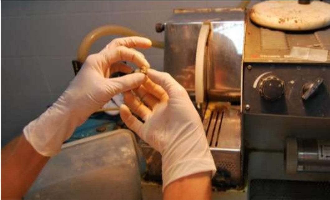
Figura 4.29. Preparación de las muestras para ser analizadas a través de MIP. Fuente: elaboración propia
