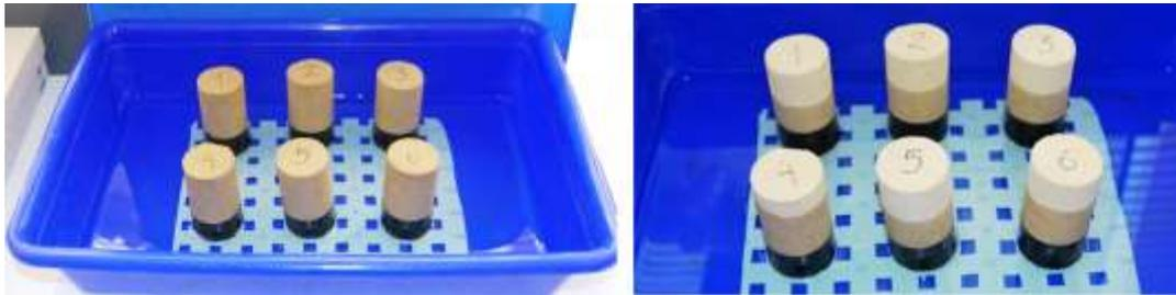
Figura 4.35. Capilaridad manual (izquierda). Detalle frente capilar (derecha). Fuente: elaboración propia
