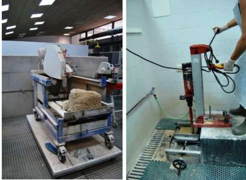
Figura 4.21. Corte de uno de los bloques de Tabaire (izquierda). Proceso de extracción de las probetas testigo (derecha). Fuente: elaboración propia
