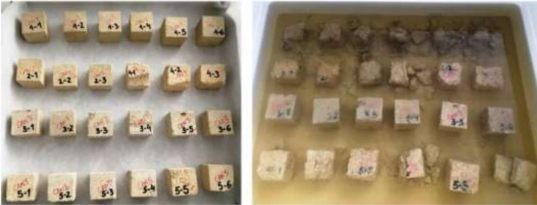
Figura 4.38. Probetas seleccionadas (izquierda). Muestras sumergidas en disolución de sulfato sódico (derecha). Fuente: elaboración propia
