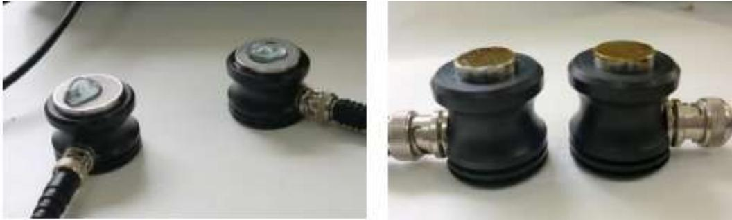
Figura 4.26. Transductores para Vp con EKO gel (izquierda). Transductores para Vs con gel SWC Couplant – Panametrics (derecha). Fuente: elaboración propia
