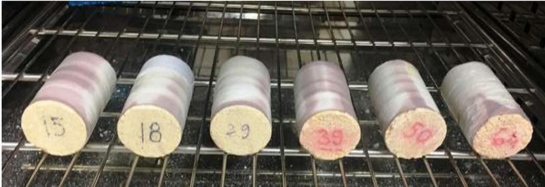
Figura 4.33. Proceso de secado de las probetas. Fuente: elaboración propia
