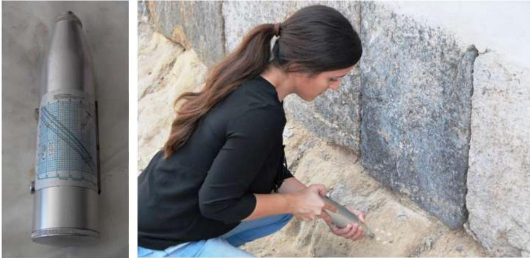
Figura 4.14. Esclerómetro Schmidt (izquierda). Toma de medidas “in situ” (derecha). Fuente: elaboración propia
