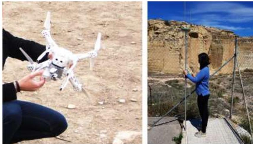
Fig. 4.18. Puesta a punto del vehículo aéreo no tripulado previo a la realización del trabajo fotogramétrico en altura (izquierda) y de la estación de tierra (GCS) (derecha). Fuente: elaboración propia
