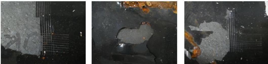
Figura 99. Muestra COLOR 9011 ensayo de enrejado tras corrosión.
