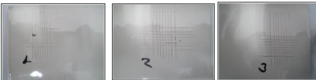
Figura 35. Muestra IMPRIMACION +LACA POLIURETANO tras el ensayo.
