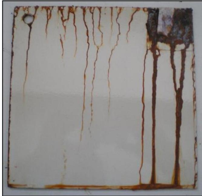
Figura 66. Imagen de la muestra G.1.2.8, tras 792 horas de ensayo
