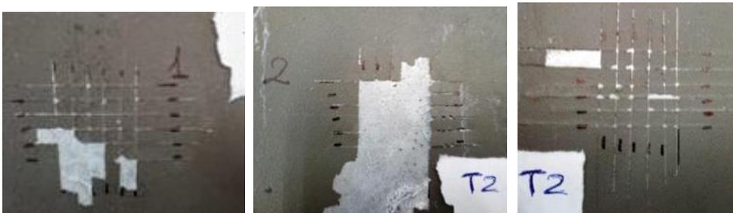
Figura 90. Muestra TITAN 2700 (T2) ensayo de enrejado tras corrosión.
