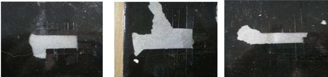
Figura 88. Muestra color 9011 ensayo de enrejado tras corrosión.
