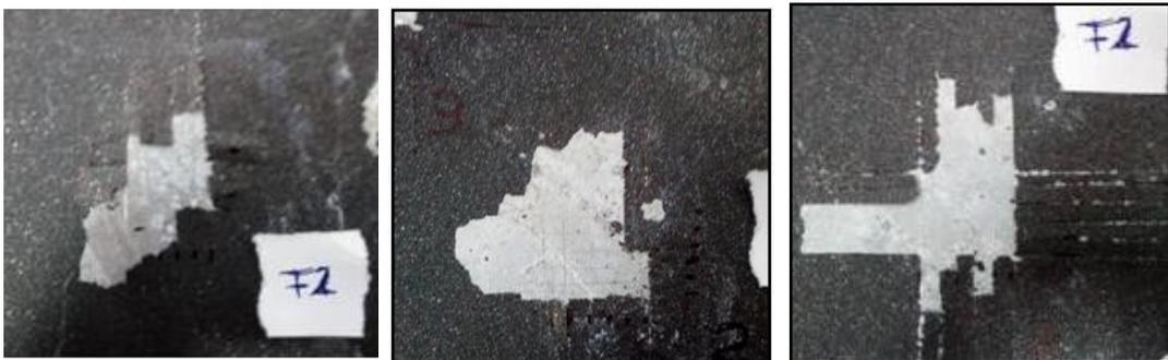
Figura 95. Muestra TIGER ensayo de enrejado tras corrosión.
