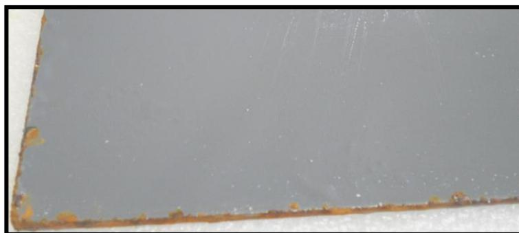
Figura 60. Imagen de la muestra G.1.2.3, tras 744 horas de ensayo.
