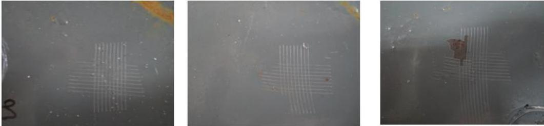
Figura 104. Muestra ADAPTA 7011 ensayo de enrejado tras corrosión.
