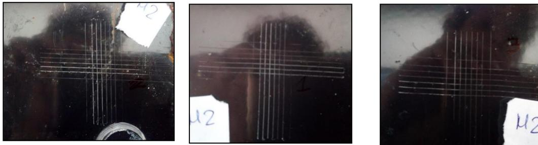
Figura 105. Muestra IMPRIMACION+ 9011 ensayo de enrejado tras corrosión.
