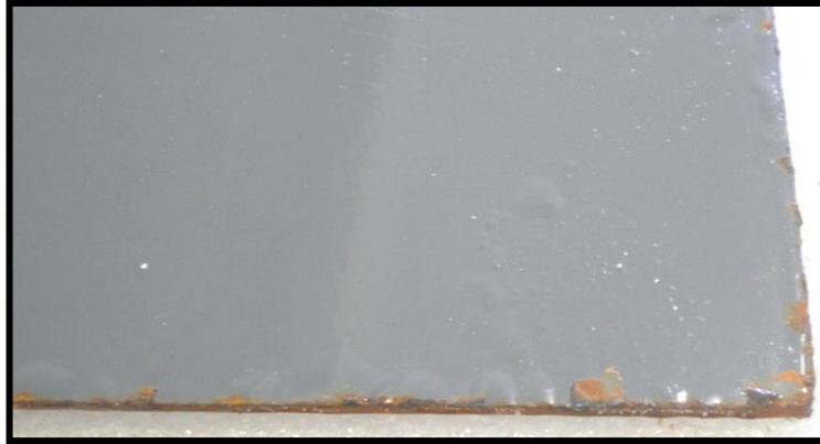
Figura 61. Imagen de la muestra G.1.2.7, tras 744 horas de ensayo.
