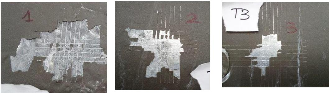
Figura 100. Muestra TITAN 2700 ensayo de enrejado tras corrosión.
