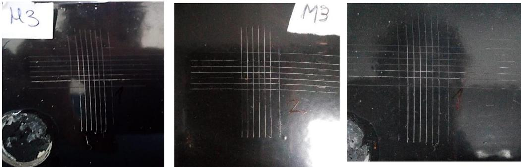
Figura 103. Muestra IMPRIMACIÓN + 9011 ensayo de enrejado tras corrosión.
