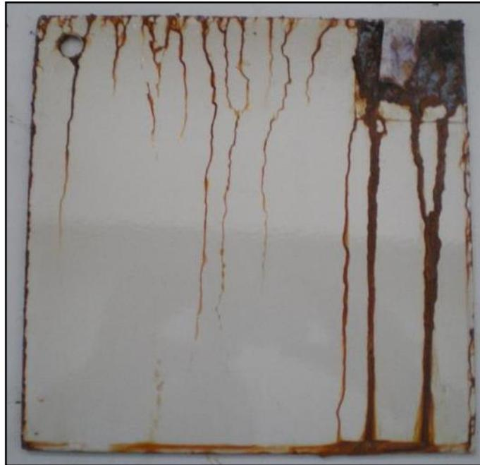
Figura 84. Imagen de la muestra G.1.2.8, tras 1.008 horas de ensayo
