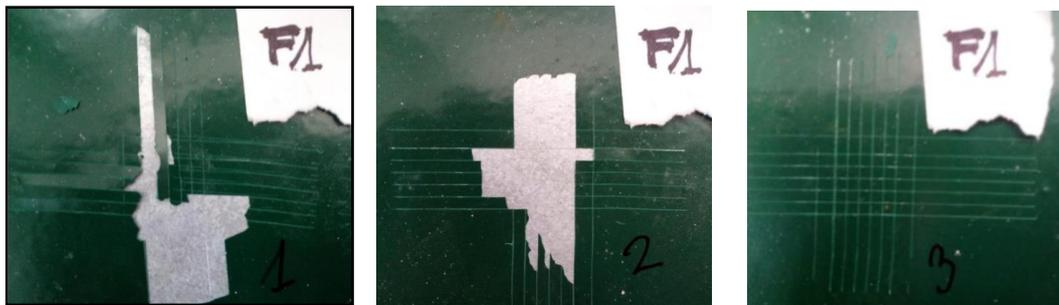
Figura 89. Muestra AXALTA 6005 ensayo de enrejado tras corrosión.
