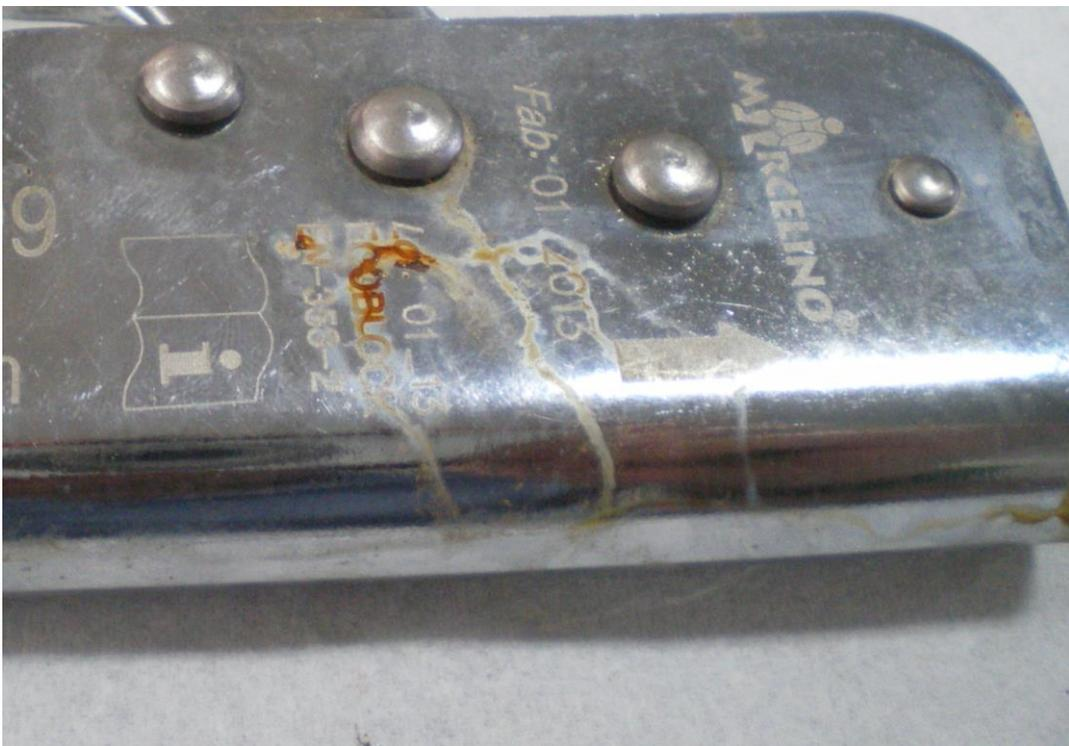
Figura 13. Corrosión por fricción. Caso particular de eliminación de la capa pasiva en grabado.
