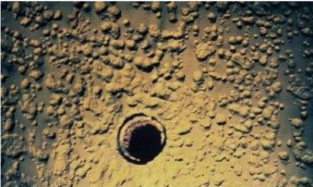
Figura 14. Corrosión por cavitación. Fuente (1).
