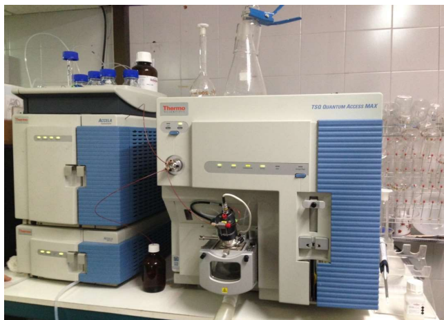
Figura 39. Cromatógrafo de líquidos
