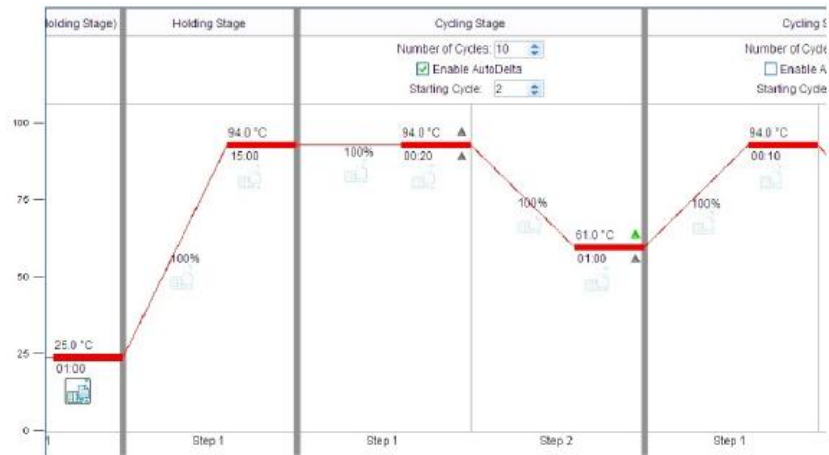
Figura 9. Esquema del programa de termociclado para el protocolo de 61 a 55°C en el que se observa la activación de la polimerasa a 94°C durante 15 minutos y la serie a temperatura de anillamiento/polimerización variable o protocolo "touchdown".
