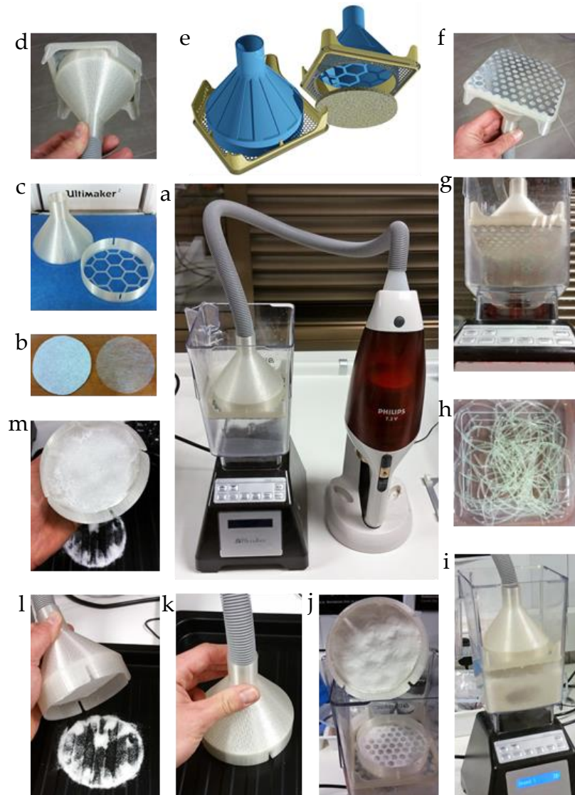
Fig. 17.33 | a , Conjunto montado. b , Filtros EVA. c , Impresión 3D de elementos. d , Tapadera de filtrado. e , Diseño CAD. f , Vista inferior. g , Cámara de triturado. h , Filamento estampado (materia prima). i , Trituradora en funcionamiento. j , Retirada del embudo sin detener el aspirador; la fracción fina queda atrapada en el filtro. k , Colocación sobre bandeja de recogida. l , Detención del aspirador; la fracción fina cae sobre la bandeja. m , Aspecto final; la mayor parte del material se ha separado del filtro.
