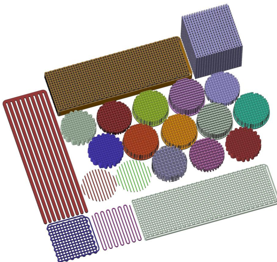
Fig. 11.2 | Selección de diseños de andamio poroso ensayados.
