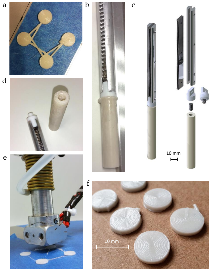
Fig. 8.8 | Impresión 3D FBF. a , Impresión FBF, sin retracción, de discos macizos. Se observa la generación de gruesos cordones de material entre los discos. b , Conjunto pistón-barra tras la unión con calor. La rebaba perimetral se limó antes de la instalación en la máquina. c , Mejora introducida: vinculación mediante rosca. d , Conjunto desmontado. Se observa como el negativo del saliente del elemento de PTFE ha quedado conformado en la barra. e , Impresión FBF tras la implementación de la retracción. Los cordones se han reducido casi completamente y han quedado restringidos a la primera capa. f , Discos (D 11 mm, H 2,5 mm) impresos con el sistema FBF.
