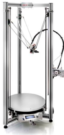
Fig. 8.1 | Impresora 3D FDM tipo delta empleada como equipo de partida para la construcción de la impresora FBF y la bioimpresora B-SPOC. Fuente: DeltaTower.ch
