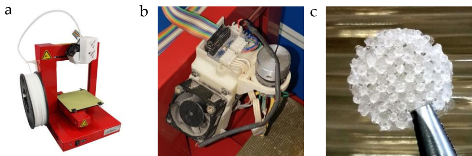
Fig. 7.2 | Impresora 3D FDM empleada. a, Vista de la impresora 3D empleada. b, Detalle de la modificación realizada (integración de un potenciómetro). c, Andamio poroso impreso.
