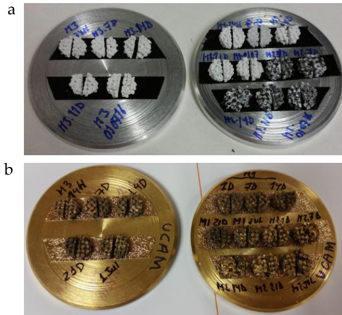
Fig. 7.6 | FESEM. Andamios de PLA-cerámica y PLA-GR montados para su observación. a, Discos montados en los pedestales. b, Conjuntos recubiertos de oro.
