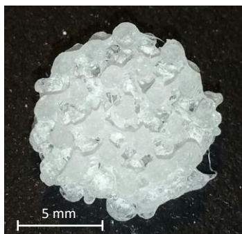
Fig. 7.4 | Andamio poroso impreso en 3D con PLA y recubierto de las cerámicas TCP-C2S en proporción 1:1.
