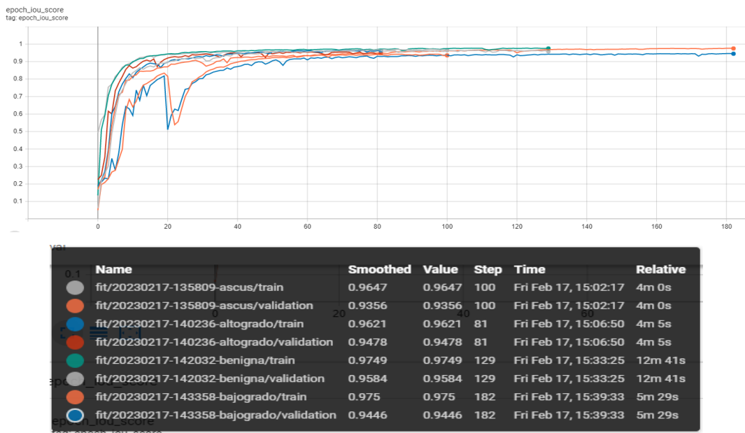
Ilustración 6.34: IoU durante el entrenamiento por modelo (arriba). Valores finales del entrenamiento (abajo) Fuente: Elaboración propia.
